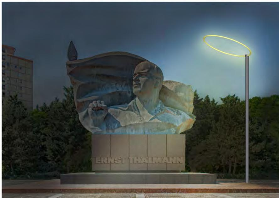
Material, Maße, Betriebszeit: warmweißes LED-Lichting Durchmesser 4,5 m, Neigung 20°; grauer Metallpfosten Höhe 14 m; Steuerung über Heiligkeitsensor, das Licht geht bei Dämmerung an
