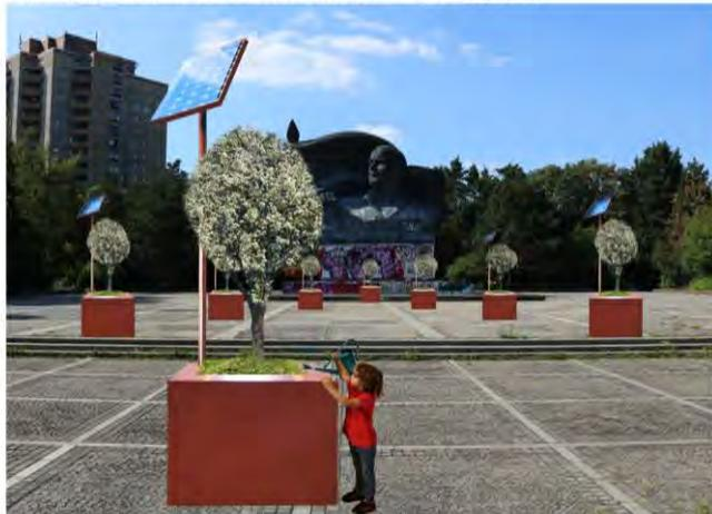
Ein Solar-Baum-Element besteht aus einem 3 m<sup>3</sup> großen Behälter aus rotem Beton, in dem eine 3 m hohe Stange mit einer Solarzelle, einem LED-Schild und einem Bewegungsmelder befestigt ist. Das Gefäß wird mit Erde gefüllt und einem 1,5 m hohen Apfelbaum der Sorte KZ-3 bepflanzt, der 3 m groß wird. Die Solar-Baum-Elemente sind 4 m hoch, überlagern aber das 13 m hohe Denkmal durch die Sichtachse von der Straße aus.
