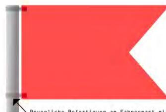
Bewegliche Befestigung am Fahnenmast mit Rundklammern
