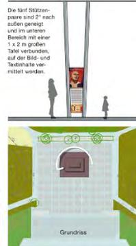
Die fünf Stützenpaare sind 2° nach außen geneigt und im unteren Bereich mit einer 1 x 2 m großen Tafel verbunden, auf der Bild- und Texttafeln vermittelt werden.
